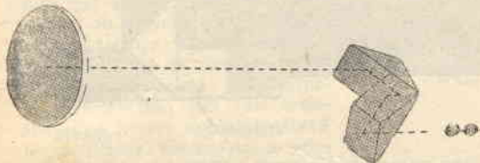
Fig. 1. — Disposizione schematica della parte ottica del telescopio.
